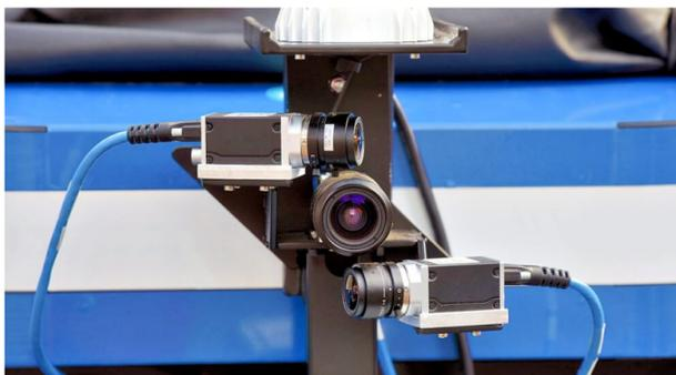
So sieht der Sensorkopf des autonomen Lastenfahrrads aus. FOTO: UTE NICKLISCH
